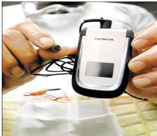
圖 3 利用 GSM 行動電話簡訊與耳塞式麥克風電子舞弊器材
