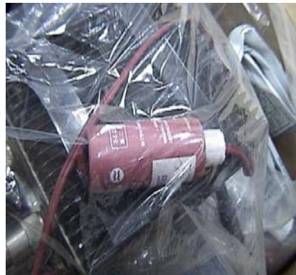
圖 2 使用改裝之呼叫器接收器與自行選定頻率發報器材之電子舞弊器材
