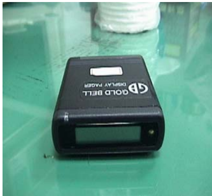
圖 2 使用改裝之呼叫器接收器與自行選定頻率發報器材之電子舞弊器材
